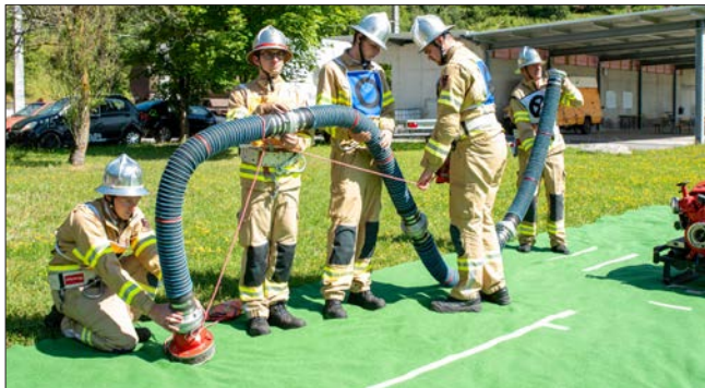
Abb. 34: Richtiger Leinenschlag vor jeder Saugschlauchkupplung (LFV Tirol)
