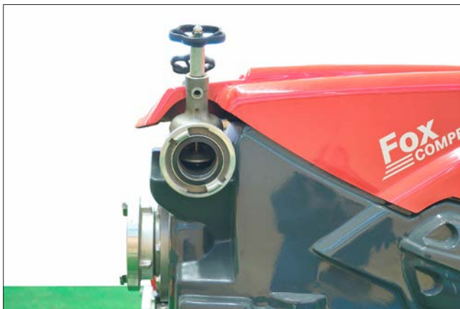
Abb. E05: Richtige Knaggenstellung TS-Ausgang (ÖBFV)
