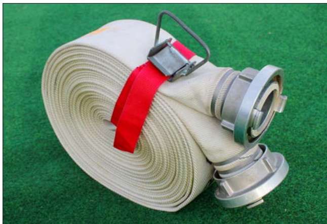
Abb. 2: Doppelt gerollter Druckschlauch (BFKDO Oberwart)
