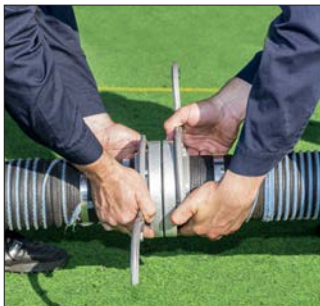
Abb. 27 und Abb. 28 sind als Bildserie zu verstehen und zeigen das Kuppeln der Saugschläuche (ÖBFV)
