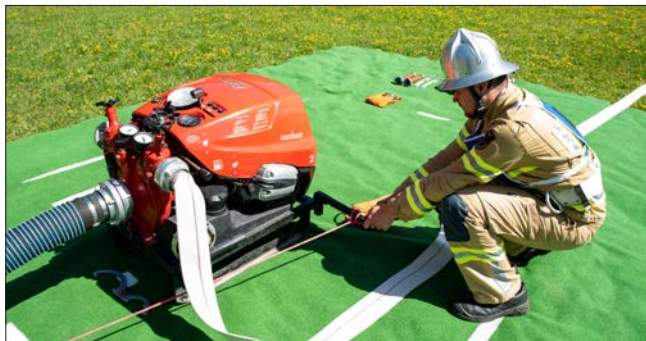
Abb. 39: Richtiges Befestigen der Saugschlauchleine (LFV Tirol)
