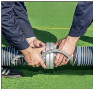
Abb. 27 und Abb. 28 sind als Bildserie zu verstehen und zeigen das Kuppeln der Saugschläuche (ÖBFV)
