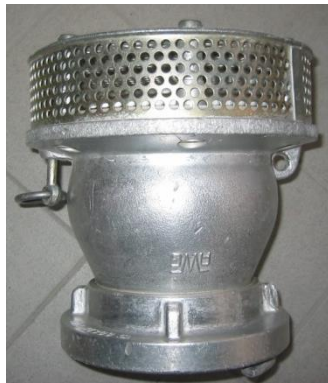
Saugkopf mit Ösen, Ring der Ventilleine muss frei beweglich sein.
